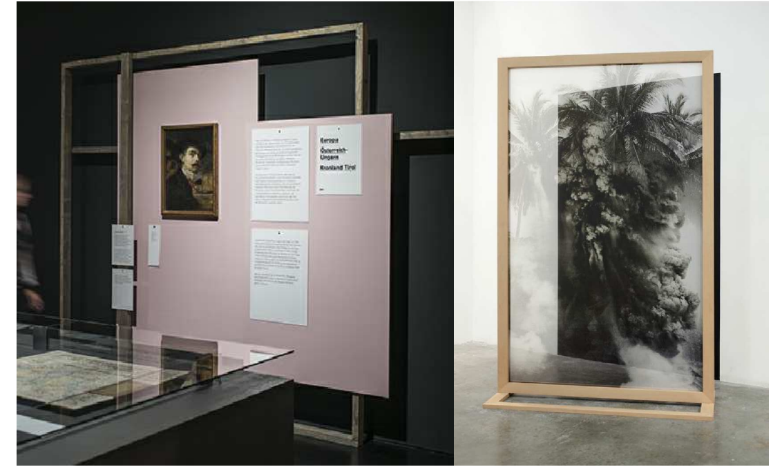
estructura de pino natural liso y uniforme de 45x21mm y tablero de dm de 16mm de diferentes tamaños acabado en pintura plástica mate color a elegir
